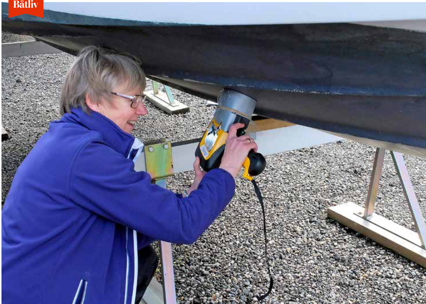
Britta Eklund med XRF-apparat för mätning av metaller på plastskrov.
