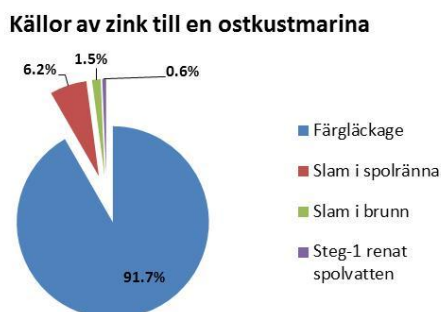
Figur 2. Olika källor av zink till en ostkustsmåbåtshamn. Procentsatserna är baserade på hur mycket zink som tillförs småbåtshamnen från en genomsnittlig bemålad båt (läcker 2,5 g Zn/båt/dag) som ligger förtöjd i småbåtshamnen under en säsong (dvs. 92 % av 5 månader) samt spolav med högtryckstvätt under höstupptag. Procentsatsen för slam och Steg-1 renat spolvatten baseras på det analyserade genomsnittliga värdet (median) av koppar och zink i dessa matriser
